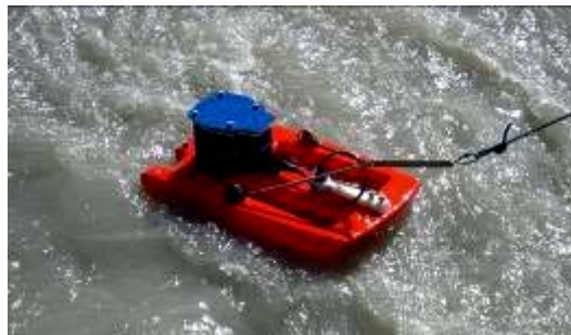
Abb. 4-20: ADCP am Boot befestigt
