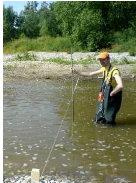
Abb. 4-23: links: Auswertung Pegelprofil Katzelsdorf, rechts: Flügelmessung (FRANK, 2008)
